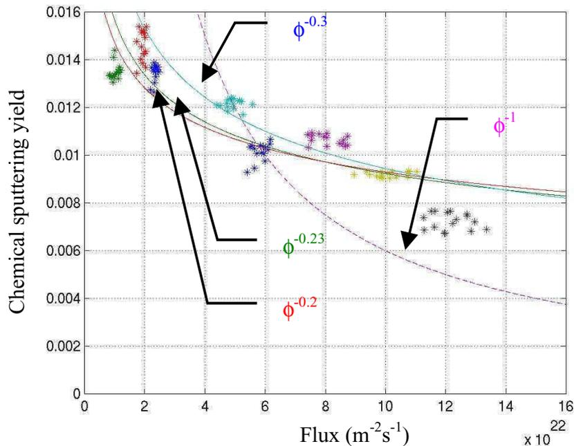
Fig. 1 :  $CD_4$  emission yield variation versus incident deuterium ions flux.
