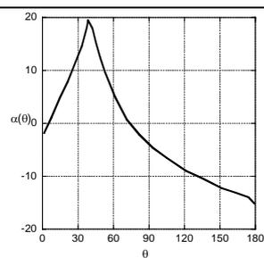
Fig. 4  $\alpha$  values vs wedge cone angle  $\theta$ .  $E_r \sim 1/r^\alpha$  [6].
